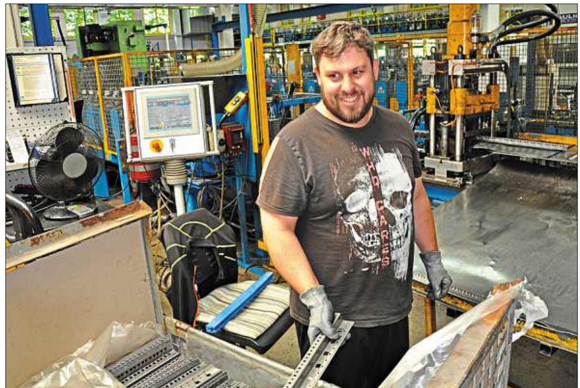
An den Profileranlagen arbeitet Christoph Rasam. Hier werden Metallbänder zu verschiedenen Profilen geformt. „Diese Arbeit macht kaum noch eine Firma in der Umgebung“, betont der stellvertretende Werksleiter Manuel Troiber. Auch im Neubau wird es wieder dieselben Arbeitsbereiche geben.
